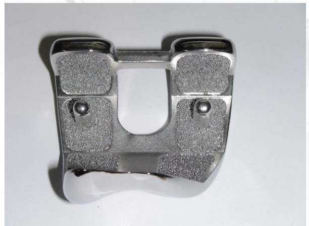
Abbildung 8 Knieimplantat mit SMT behandelt
